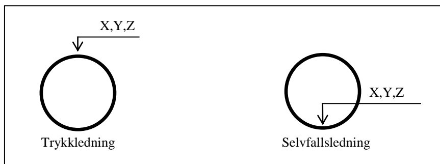
Figur 1. Måling av ledningshøyde.
